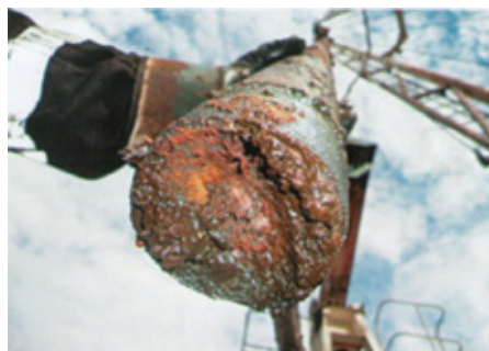
修井时从井下取出的直径 73mm 无涂层油管
