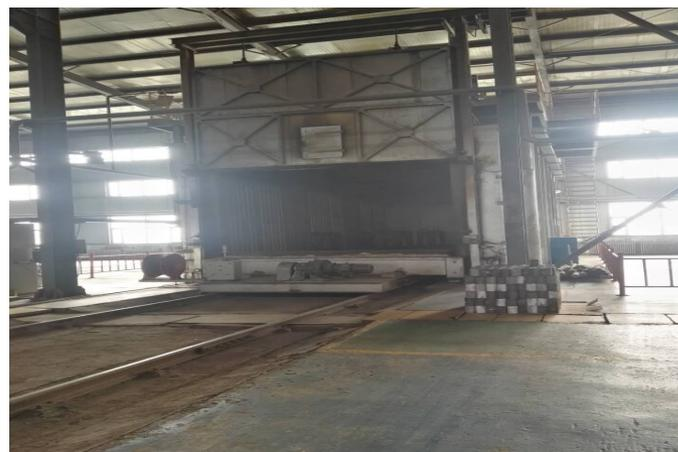
**成品固化炉：**管材面漆固化，调节温度，加速涂料凝结，300根/炉
