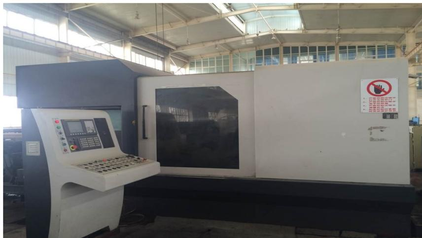
数控车床：（ $\Phi 73.02 \sim 177.8\text{mm}$ ）数量：3台
