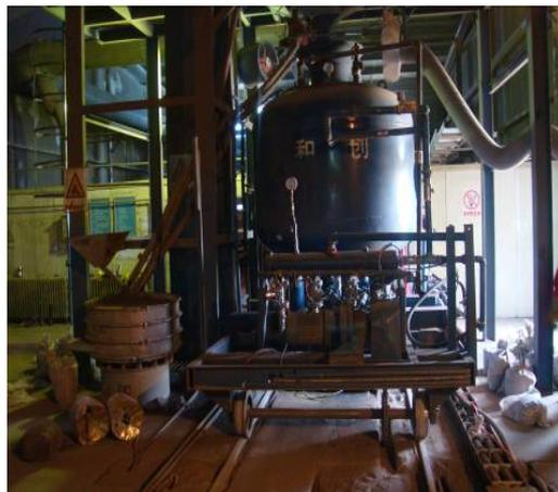
**喷砂机：**管材内壁喷砂，对内壁氧化皮、碱层进行处理，80根/班
