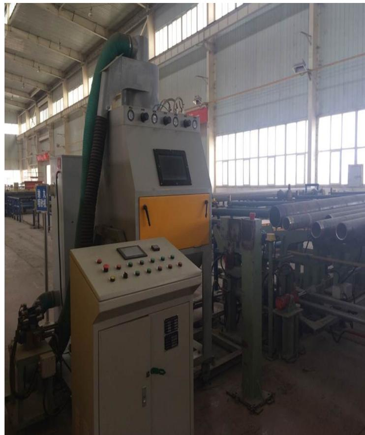
**抛丸喷砂机：** LW/PS1-YG7可实现对10"以下的工具螺纹进行表面处理，满足表面处理技术要求。
