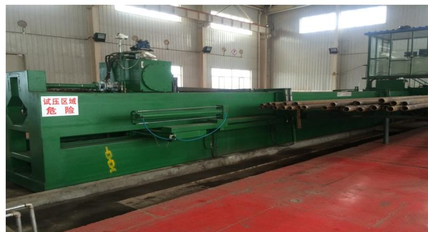
BCH/SY-114型静水试压机：, 2台
