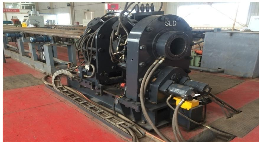
无牙痕拧接机SLD4 12-25：实现无损伤拧扣 1台
