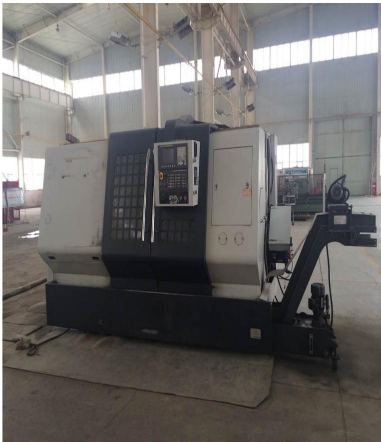
**数控车床：** HTC5020B（ $\Phi 60.32\sim 114.3\text{mm}$ ）数量：2台，主要进行油管短节加工，接箍加工。
