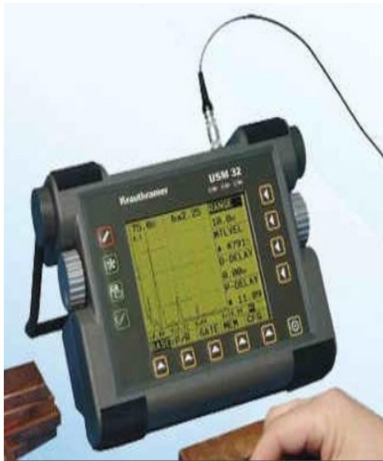
**无损检测仪器：**超声波探伤机仪专用于油套管短节管体探伤
