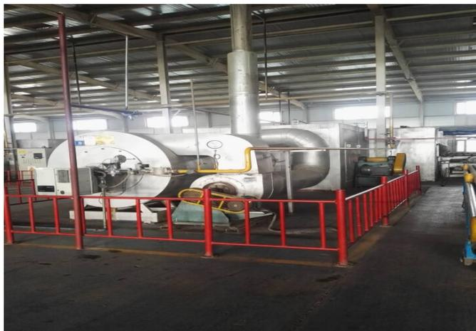
**水平链式炉：**管材底漆固化，加速涂料凝结及附着力，150根/班
