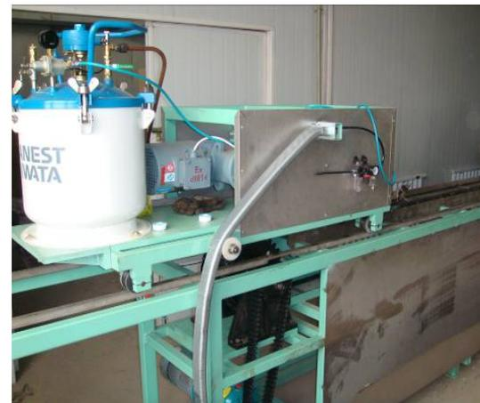
**喷涂设备：**内壁喷涂，均匀覆盖管壁，100根/班
