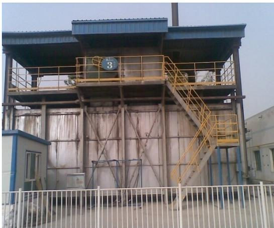
**热洁炉：**辐射加热200-400℃，对稠油、碱层进行碳化疏松，300根/炉
