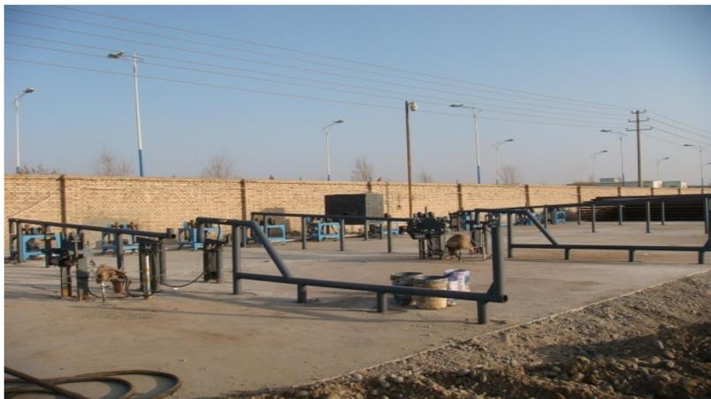
**内外壁除锈**：自主设计内外壁除锈机，每班350根
