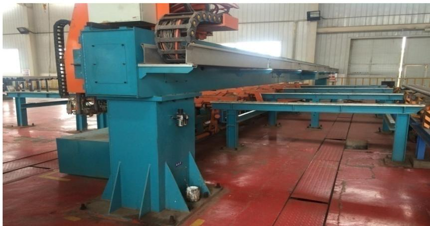
SST-114超声波探伤机：(Φ73~114.3mm) 1台
