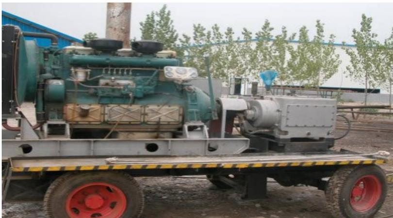
**高压清洗机**：压力10-40MPa可调可控，油套管的清洗效果显著，效率高。
