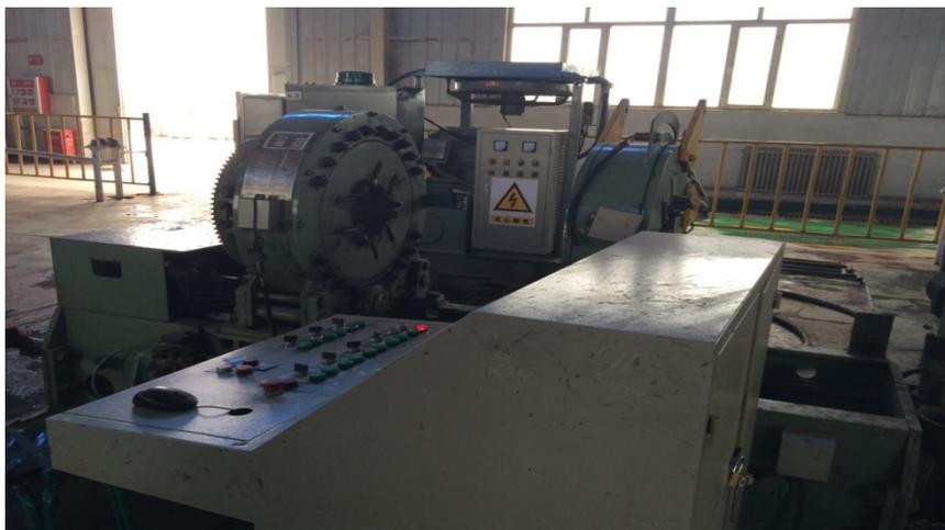
拧扣机：（ $\Phi 60.33 \sim 140\text{mm}$ ）数量：4台
